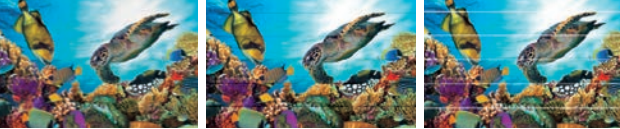
Posición de caída de gota bidireccional incorrecta Superposición / rayas negras (Alimentación de papel insuficiente) Espacio / rayas blancas (Alimentación de papel excesivo)
